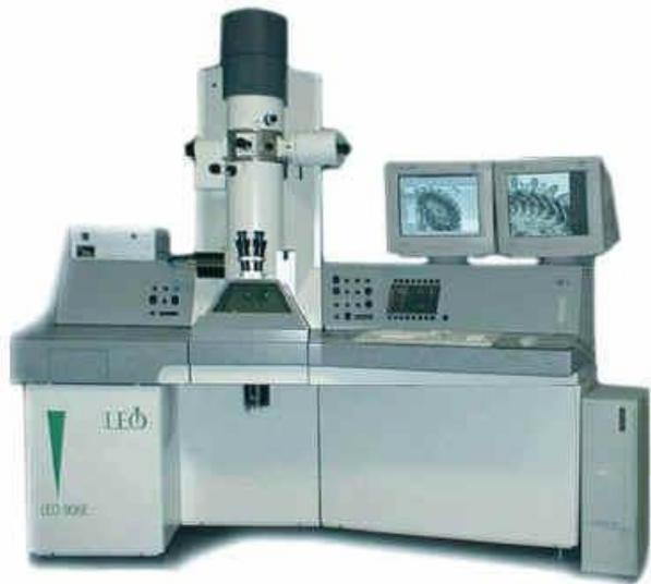
Fig. 1.8 Fotografia do microscópio eletrônico de transmissão 906E.
